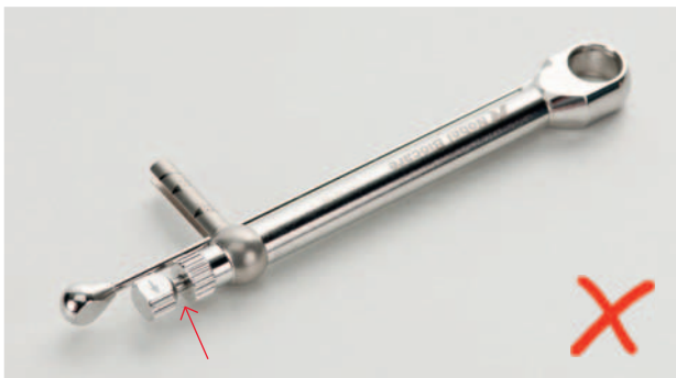
Richtungsindikator bewegt sich nicht vollständig zurück ins Rohr
