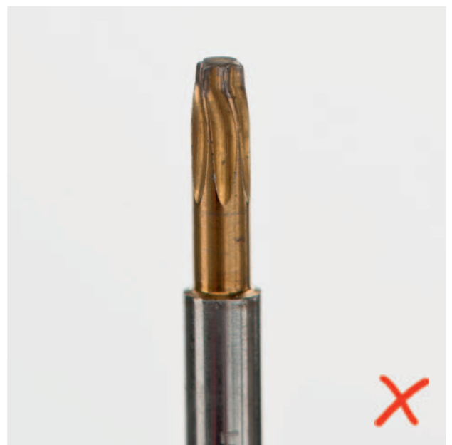
Verformte und abgenutzte Spitze
