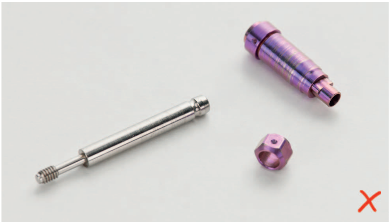
Defekter Guided Einbringpfosten
