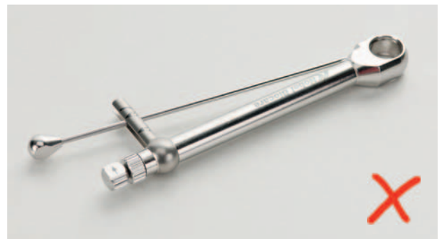
Feder ist aufgrund von Überladung verbogen
