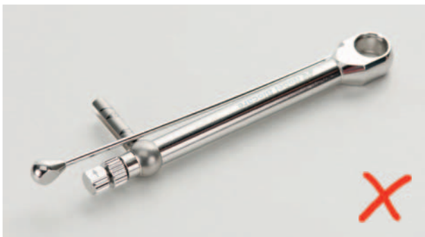
Feder aus der Führungssäule gesprungen
