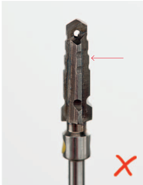
Schneidekanten sind stumpf/abgenutzt
