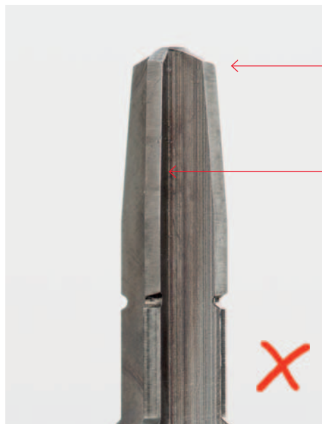
Schneidekante mit nachlassender Schärfe
