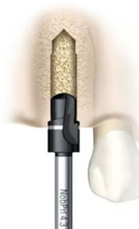
Velocidade máxima de 2000 rpm e perfure até à profundidade adequada.
