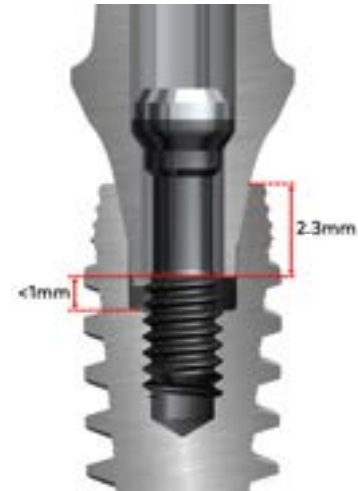
アバットメントの最終位置において、接合面底部のスペースは1 mm 未満です。
