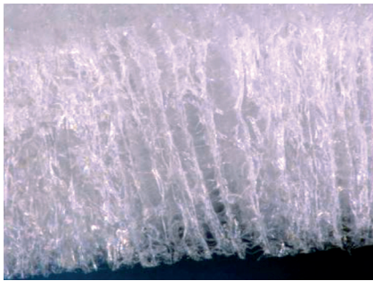
1. Structure de la matrice Structure poreuse et interconnectée produite par un procédé breveté. 4,5,6
