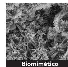
Biomimético Fosfato cálcico sintético convencional (HA/B-TCP) Proceso de fabricación a baja temperatura: los cristales de hidroxiapatita crecen de forma lenta para imitar la estructura y composición del hueso humano.
