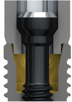
Asentamiento en el hombro para puente NobelProcera sobre implantes
