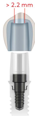
El diámetro del canal de acceso al tornillo para la versión de diámetro reducido ha de ser **> 2.2 mm.**
