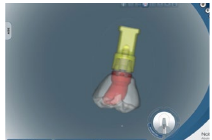
Dopo la scansione della ceratura (mediante lo scanner NobelProcera 2G), si procede con il disegno di una corona molare, mediante il software NobelProcera.
