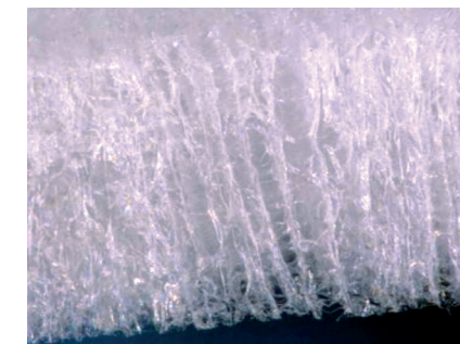
1. Matrixstruktur Vernetzte poröse Struktur durch einen patentierten Prozess. 4,5,6
