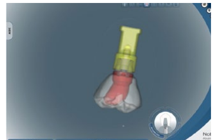
Nach dem Scannen des Wax-ups (unter Verwendung des NobelProcera 2G Scanners) wird eine Molarenkrone mithilfe der NobelProcera Software entworfen.
