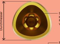
Die Verbindungsgeometrie bietet Rotationsschutz für eine starke und feste Verbindung.
