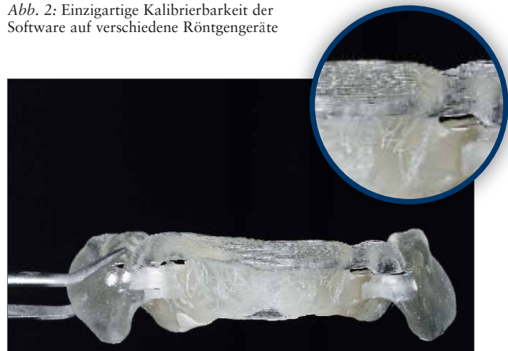
Abb. 4: Schichtstruktur der stereolithografisch erstellten Schablone
