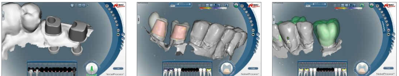
Abb. 13: Konstruktion der Abutments und der Kronencopings aus der Zahndatenbank
