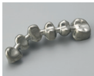
Abb. 4 Durch die maschinelle Bearbeitung entfallen bei der Bearbeitung von Titan oder Titan-Legierungen verfahrenstechnische Schwierigkeiten gegenüber dem Guss (Bild: Straumann).
