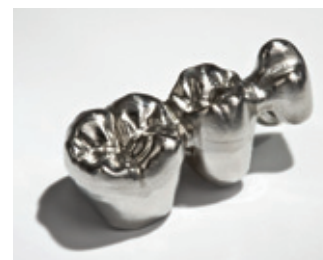
Abb. 5 CoCr-Legierungen zu fräsen ist anspruchsvoller als Zirkoniumdioxid (Bild: Heraeus).
