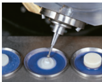
Abb. 9 Feinste Bearbeitung von Silikatkeramikblöcken (Bild: KaVo).
