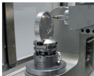
Abb. 3 Bei CoCr-Legierungen spielen gute maschinelle Verarbeitbarkeit und hohe Materialqualität eine Rolle für die Maschinenbearbeitung (Bild: R+K CAD/CAM-Technologie).
